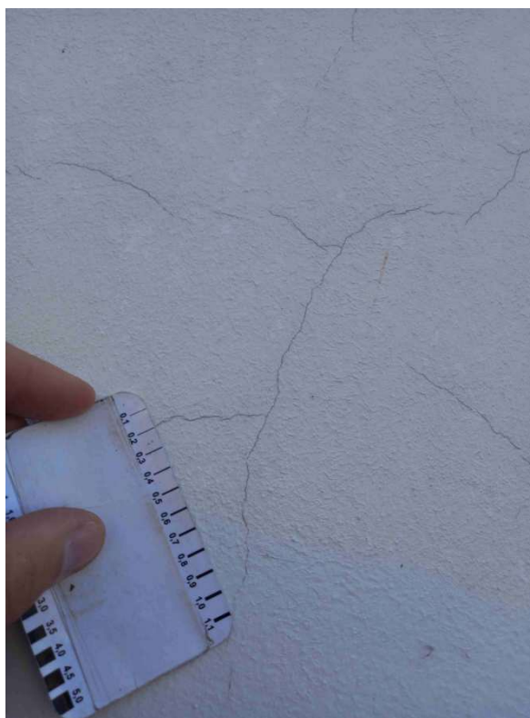
Šírka trhlin 0,2 mm
