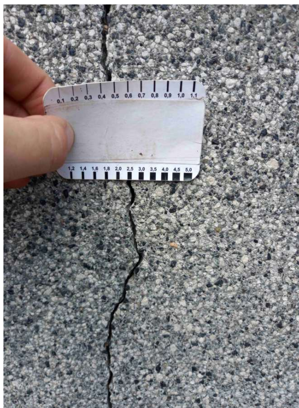
Šířka trhliny 2,5 mm
